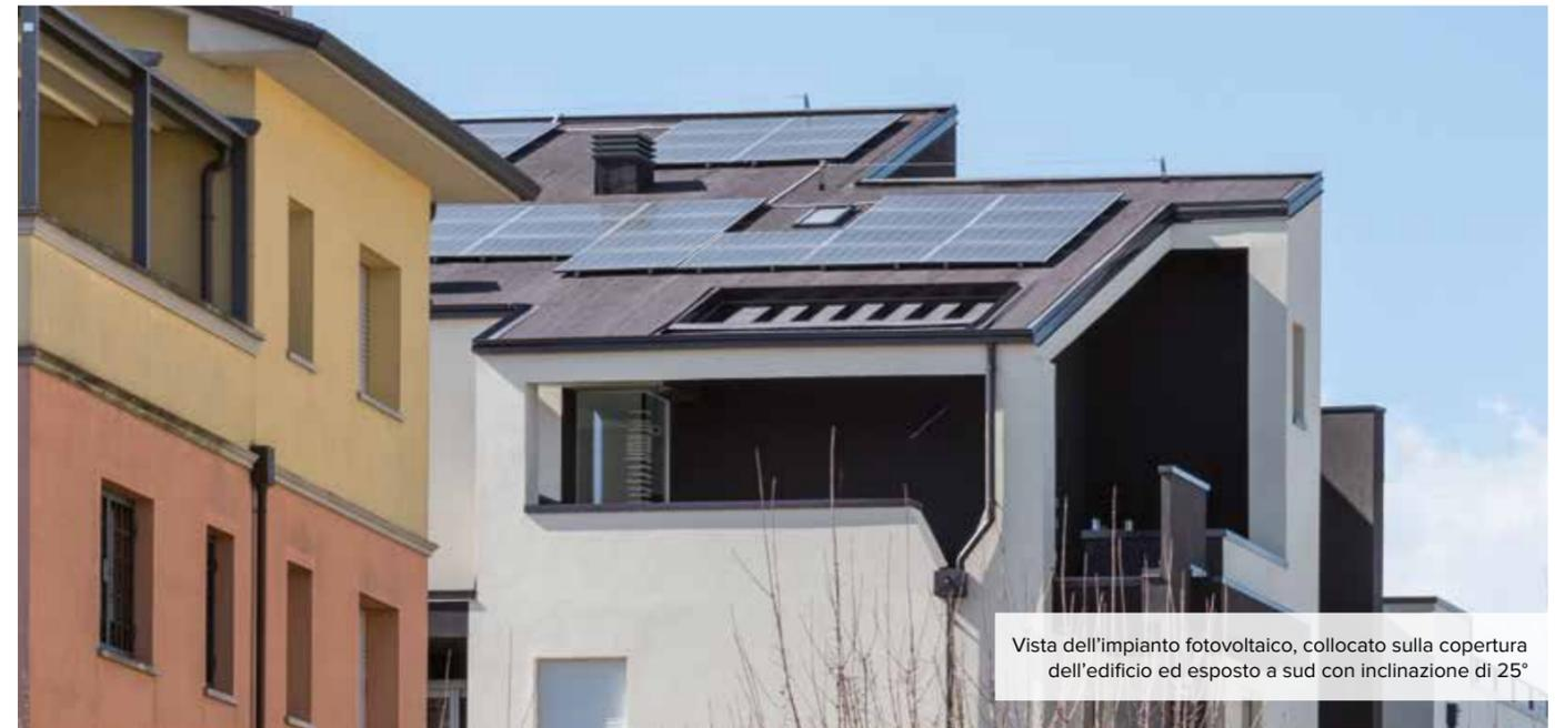
Vista dell'impianto fotovoltaico, collocato sulla copertura dell'edificio ed esposto a sud con inclinazione di 25°
