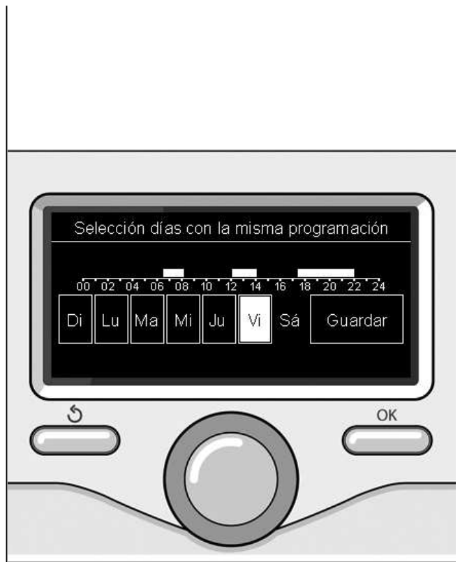
Seleccionar días programación horaria calefacción
