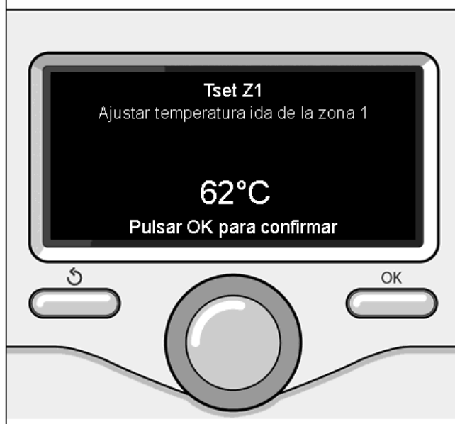
Modificar la temperatura agua caliente calefacción
