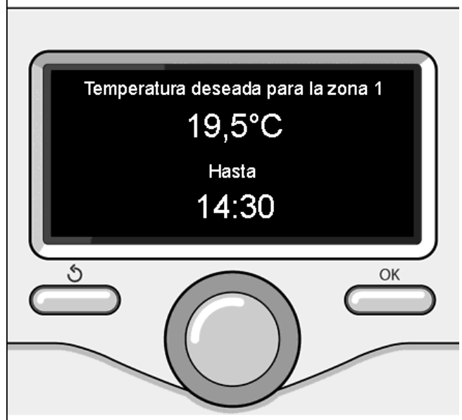
Modifica la temperatura ambiente en modo programación por tiempo
