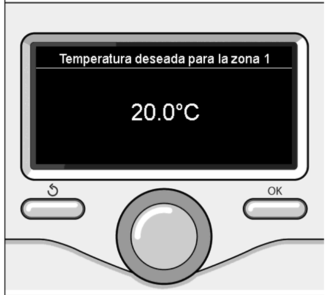
Modificación de la temperatura ambiente
