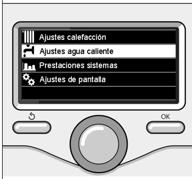
Seleccionar programación agua caliente
